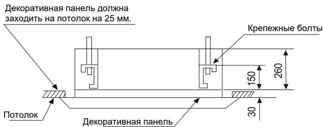
Примечание: проектный размер встраиваемой части панели PB-700IB составляет 577\*577 мм.
