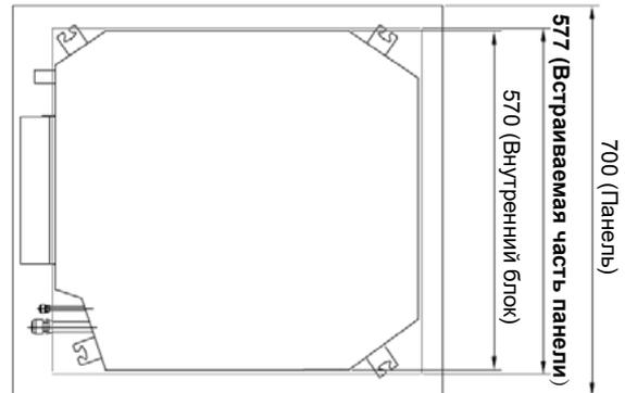
Примечание: для правильной установки панели PB-700KB минимальный размер монтажного отверстия в потолке должен быть более 577 мм.
