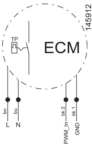
Для плавного регулирования скорости вращения с помощью ШИМ на вход PWM\_In должен быть подан ШИМ-сигнал с частотой 1-5 кГц и амплитудой 5-10 В.
